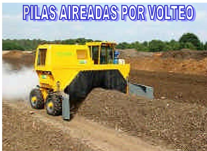
Los montones o pilas son aireados por volteo mediante retroexcavadoras (también existe en el mercado maquinaria específica para airear las pilas, como se muestra en la fotografía) o por aireación forzada, que consiste en hacer pasar a través de las pilas de compost una corriente de aire para acelerar la descomposición de la materia orgánica.
